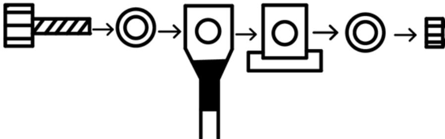
**Figure 1 :** Ordre correct du matériel pour connecter les câbles. En allant de gauche à droite dans le diagramme, l'ordre correct est le suivant : boulon, rondelle, cosse, borne, rondelle et écrou. Si plusieurs cosses sont utilisées, elles doivent se trouver du même côté de la borne.
